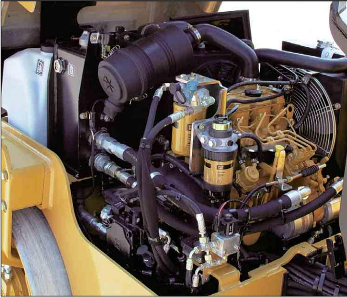
**Puissance.** Le Moteur C1.5, trois cylindres refroidi par eau, développe une puissance brute de 24,6 kW (33 ch) pour offrir de bonnes performances et une grande fiabilité dans toutes les conditions de travail.
