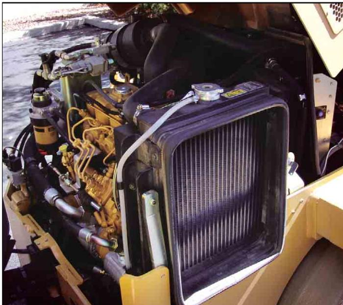
**Facilité d'accès.** Le capot moteur à relevage vertical facilitant l'accès au filtre à huile moteur, au filtre hydraulique, au bloc de vibration, au radiateur et aux pompes de translation permet un entretien régulier et rapide.
